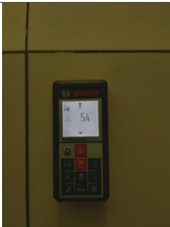
Фото № 35 Уклон марша пандуса с одной стороны двери - 5,4^{\circ}
